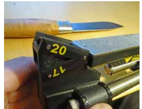
På hver ende av slipeområdet sitter en vendbar mal med 20 og 17 graders vinkel.
