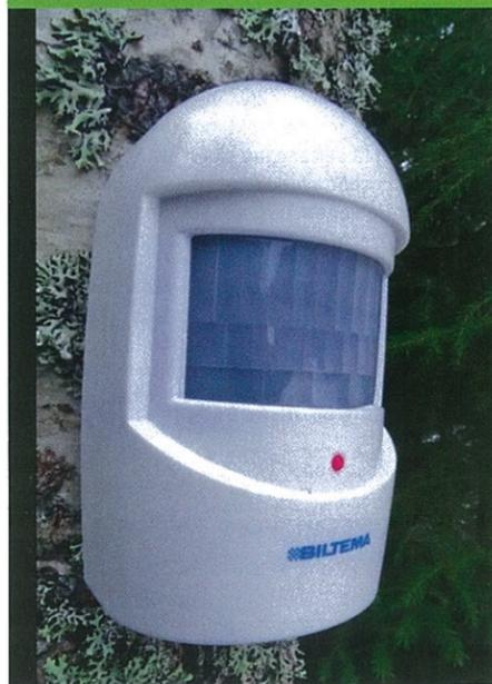
Kan en revevarsler til under 200 kroner være noe tress? Vi plukket Biltemas overvåkingsalarm ned fra hylla og ga den en sjans. Systemet består av en IR-sensor med sender som plasseres på åtet og en mottager med alarm som plasseres der du befinner deg. Sensoren slår ut på store dyr på opptil 30 meters avstand. For mindre vilt er deteksjonsavstanden kortere. Dette er imidlertid fullt på høyde med det dagens viltkameraer presterer, og sensoren fungerer greit ved på åteplass.
